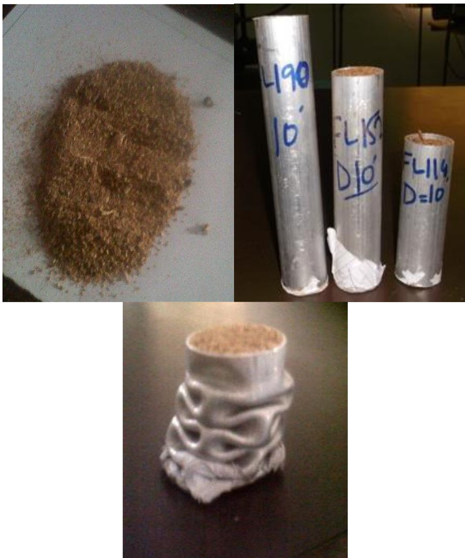
شکل (۴-۲) تصاویر مچالگی لوله آلومینیومی حاوی خاک اره
